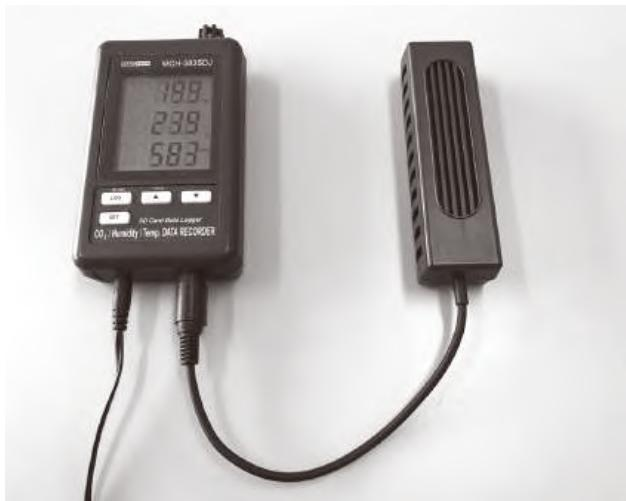
写真5 サトテック製CO<sub>2</sub>濃度計
